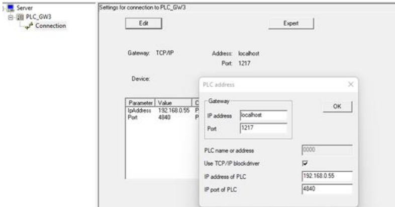
Рис. 3.50. Настройка IP-адреса и порта шлюза
