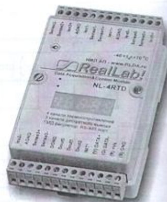
Рис. 1. Внешний вид модуля ввода сигналов резистивных датчиков температуры
