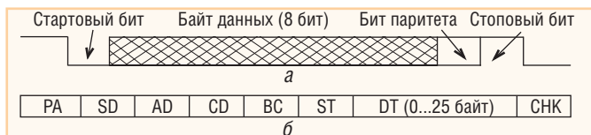
Рис. 4. Структура слова (а) и сообщения (б) в HART-протоколе
