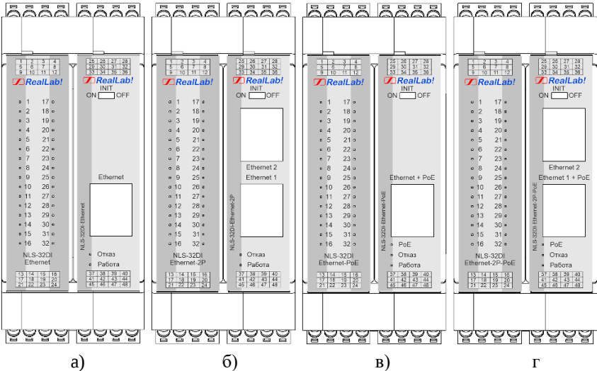
Рис. 4.1. Расположение органов индикации на лицевых панелях модулей а) NLS-32DI-Ethernet, б) NLS-32DI-Ethernet-2P, в) NLS-32DI-Ethernet-PoE, г) NLS-32DI-Ethernet-2P-PoE
