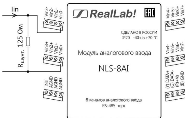
Рис. 5.5. Подключение шунтирующего резистора на первый канал модуля NLS-8AI для измерения тока в диапазоне \pm 20 мА, в дифференциальном режиме
