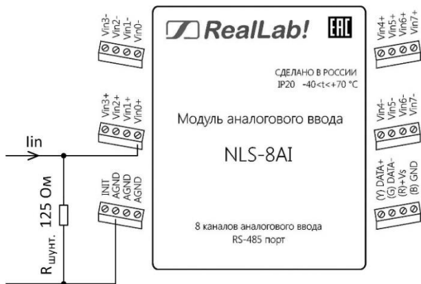
Рис. 5.4. Подключение шунтирующего резистора на первый канал модуля NLS-8AI для измерения тока в диапазоне \pm 20 мА, в одиночном режиме
