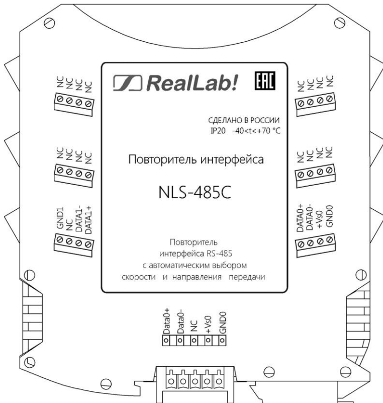
Рис. 1.1 Вид со стороны маркировки на модуль NLS-485C
