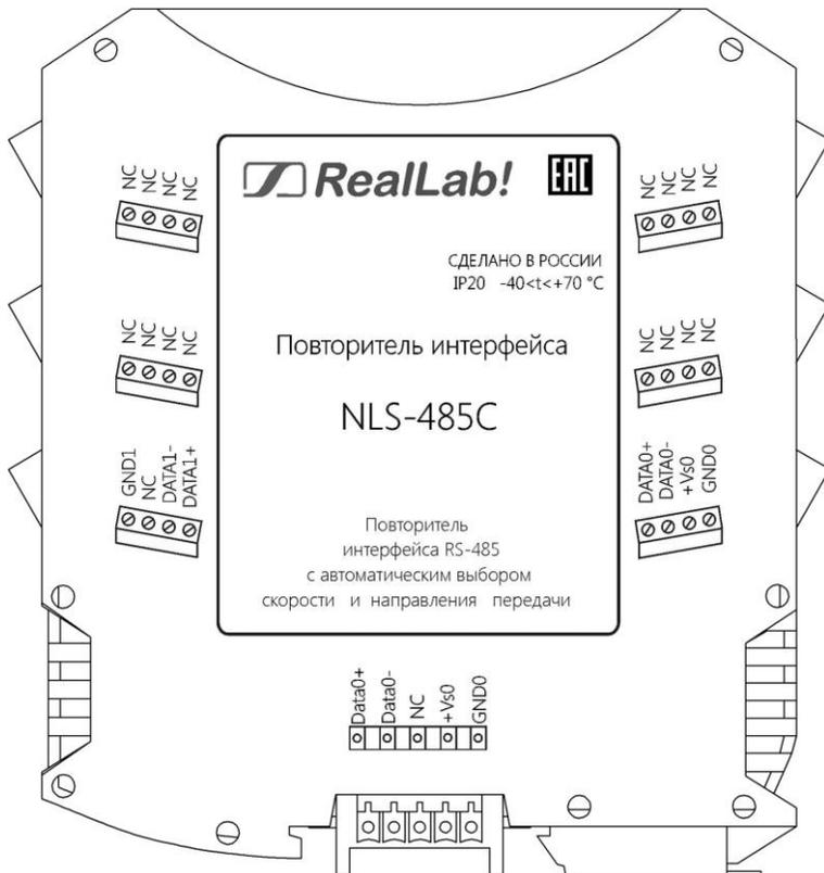
Рис. 1.1 Вид со стороны маркировки на модуль NLS-485C
