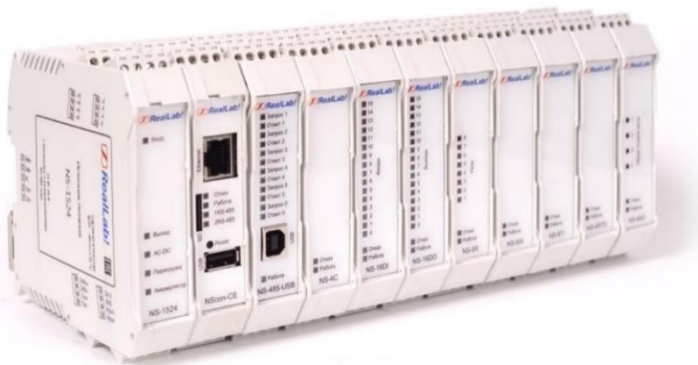
Рис. 1.2. Расположение модулей серии NLS на DIN-рейке
