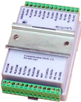
Рис. 5.1. Чтобы закрепить один модуль сверху другого, сначала закрепите DIN-рейку сверху модуля
