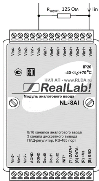
Рис. 6.8. Подключение шунтирующего резистора на первый канал модуля NL-8AI для измерения тока в диапазоне \pm 20 мА, в дифференциальном режиме
