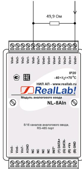
Рис. 5.9. Подключение шунтирующего резистора на 0 канал модуля NL-8AIn, NL-8AIn-3 для измерения тока в диапазоне  $\pm 25$  мА в дифференциальном режиме
