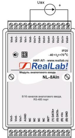
Рис. 5.6. Схема подключения для измерения сигналов  $\pm 10$  В,  $\pm 5$  В,  $\pm 1$  В,  $\pm 500$  мВ,  $\pm 150$  мВ на 0-ом канале модулей NL-8AIn и NL-8AIn-3 в дифференциальном режиме
