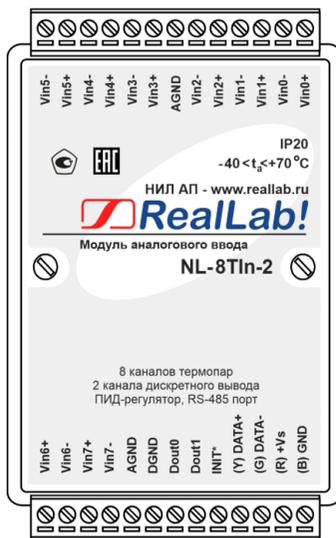
Рис. 1.4. Вид сверху на модуль NL-8TIn-2
