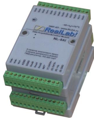
Рис. 5.2. Крепление одного модуля на другой
