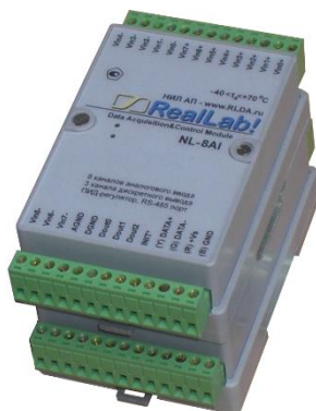
Рис. 6.5. Крепление одного модуля на другой
