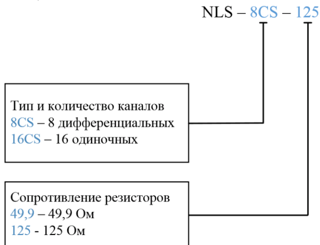
Рис. 1.1. Обозначение модулей NL-8CS и NL-16CS
