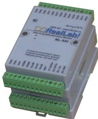
Рис. 4.2. Крепление одного модуля на другой
