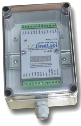
Рис. 4.3. Модуль серии NL в пылевлагозащищенном корпусе IP65
