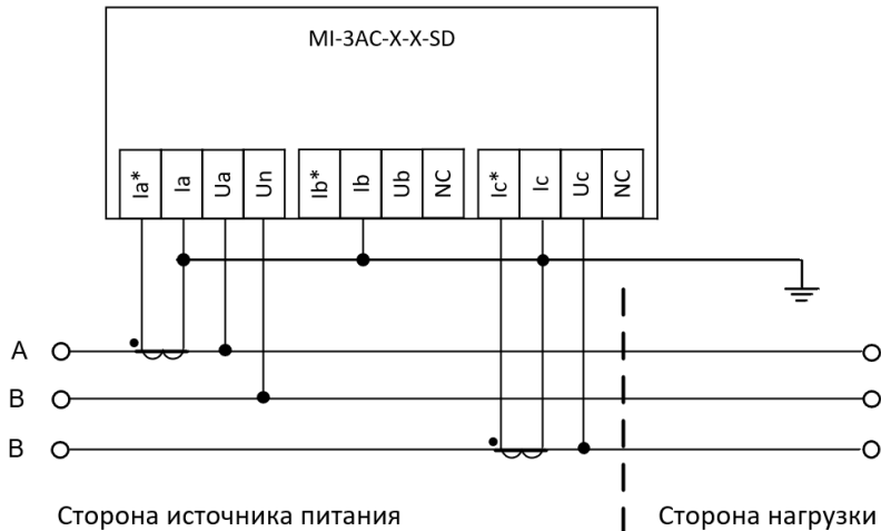
Рис. 4.7. Схема полукосвенного (2-х трансформаторного) трёхфазного подключения (3Ф3П)
