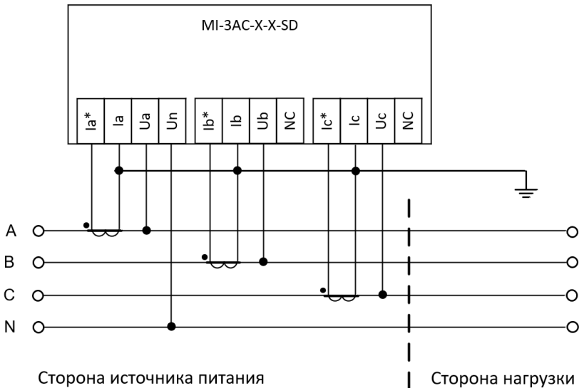
Рис. 4.8. Схема полукосвенного (3-х трансформаторного) трёхфазного подключения (3Ф4П)
