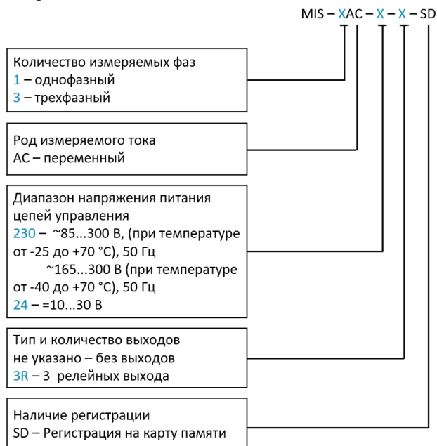
Рис. 1.1. Модификации измерителей серии MIS
