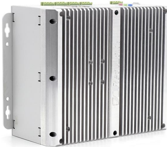
Рис. 1.1. Внешний вид встраиваемого ПК
