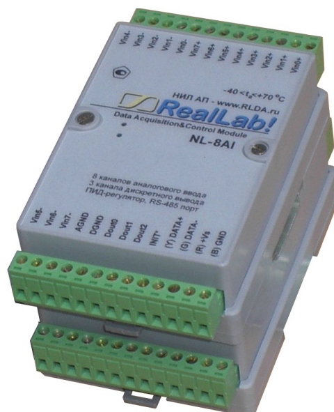
Рис. 6.5. Крепление одного модуля на другой
