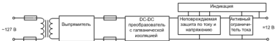
Рис. 3.1. Структурная схема источника питания
