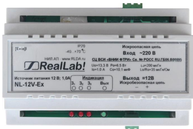
Рис. 1.2. Источник питания NL-12V-Ex. Вид сверху.
