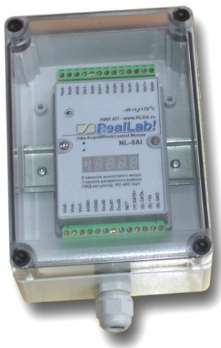
Рис. 4.5. Модуль серии NL в пылевлагозащищенном корпусе IP66
