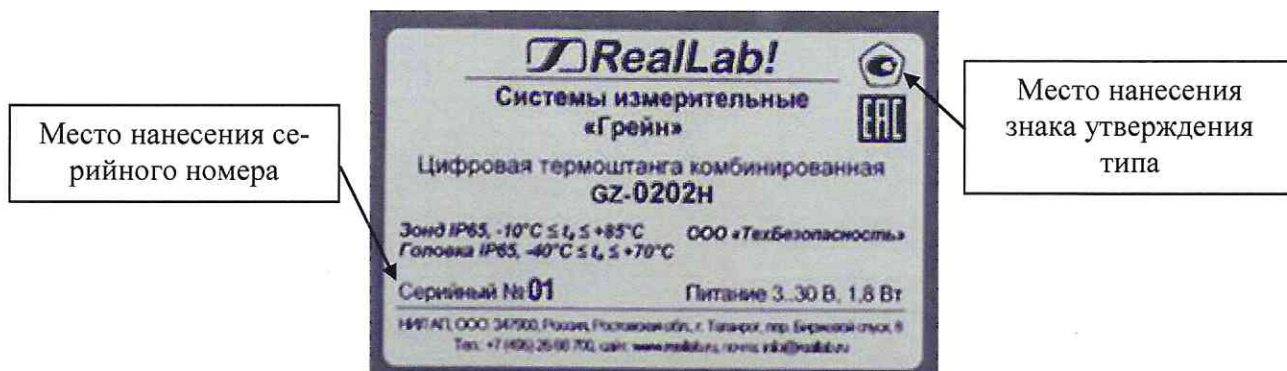
Рисунок 4 - Маркировочная табличка с указанием места нанесения серийного номера, места нанесения знака утверждения типа
