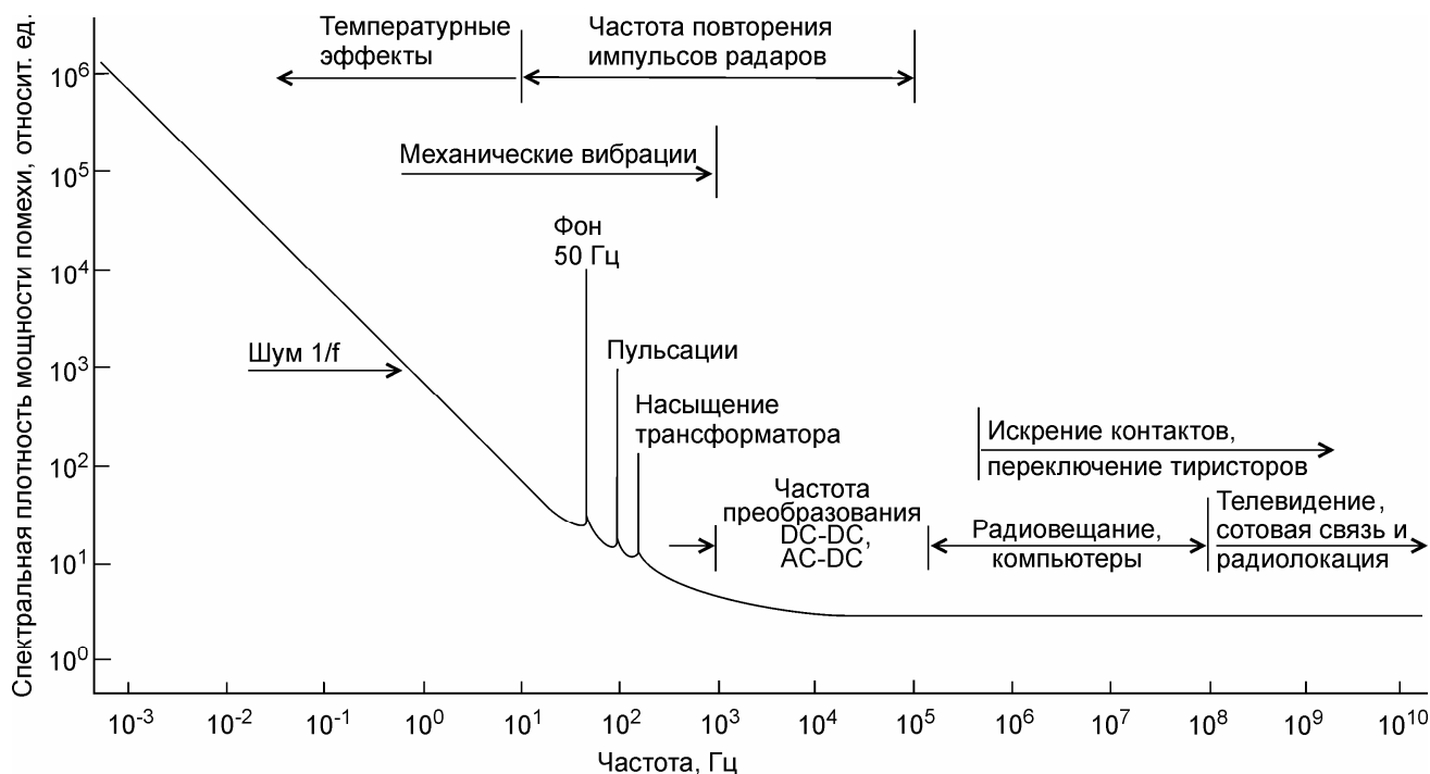
Рис. 7. Относительный уровень спектральной плотности мощности и частоты основных источников электромагнитных помех
