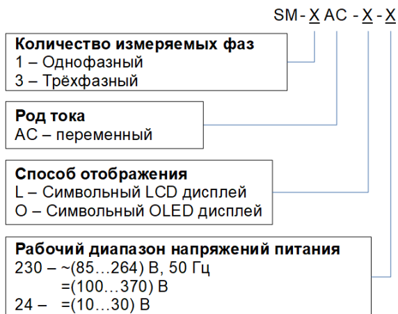
Рис. 1.1. Модификации счетчиков SM-1АС и SM-3АС
