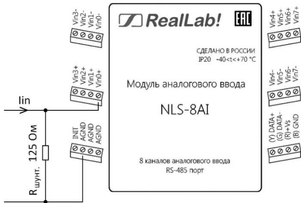
Рис. 5.5. Подключение шунтирующего резистора на первый канал модуля NLS-8AI для измерения тока в диапазоне \pm 20 мА, в одиночном режиме
