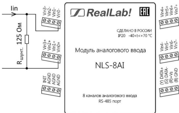
Рис. 5.6. Подключение шунтирующего резистора на первый канал модуля NLS-8AI для измерения тока в диапазоне \pm 20 мА, в дифференциальном режиме
