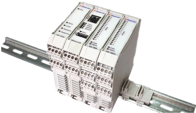
Рис. 1.4. Расположение модулей серии NLS на DIN-рейке
