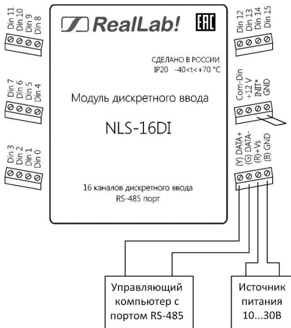
Рис. 5.3. Соединение вывода INIT* с "землей" для изменения скорости обмена и контрольной суммы
