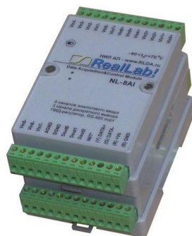
Рис. 3.2 Крепление одного модуля на другой
