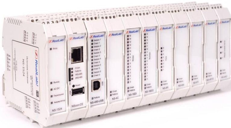
Рис. 1.5. Расположение ПЛК и модулей серии NLS на DIN-рейке
