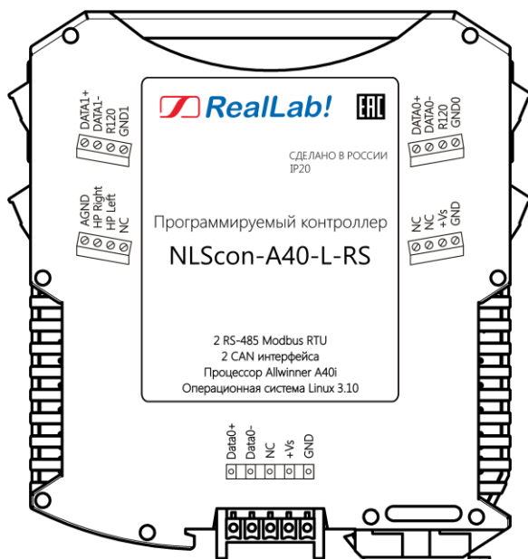
Рис. 1.2. Вид левой стороны маркировки на ПЛК NLScon-A40-L-RS
