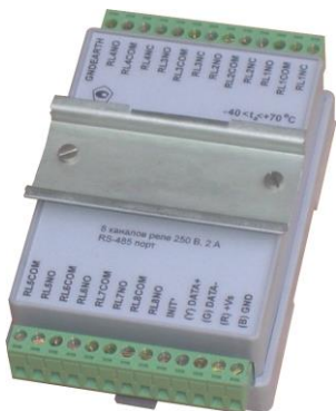
Рис. 5.1. Чтобы закрепить один корпус «RealLab!» сверху другого корпуса «RealLab!», сначала закрепите DIN-рейку сверху корпуса
