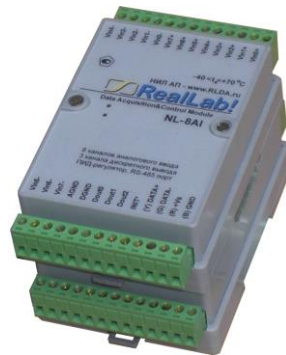
Рис. 5.2. Крепление одного модуля на другой
