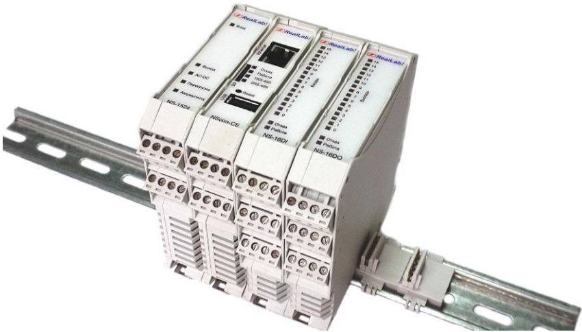
Рис. 3.1. Расположение в ПЛК модулей серии NLS на DIN-рейке
