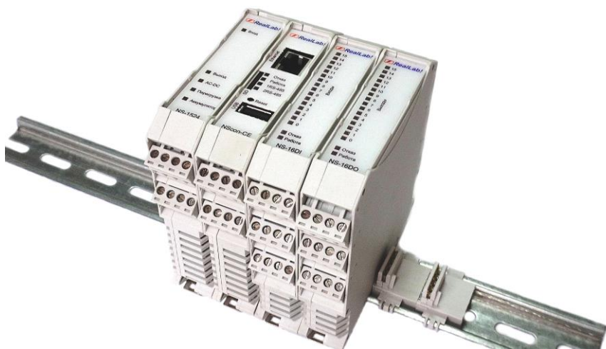
Рис. 2.4. Расположение модулей серии NLS на DIN-рейке
