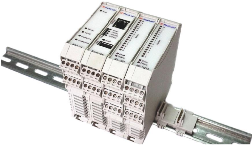
Рис. 1.2. Расположение модулей серии NLS на DIN-рейке.
