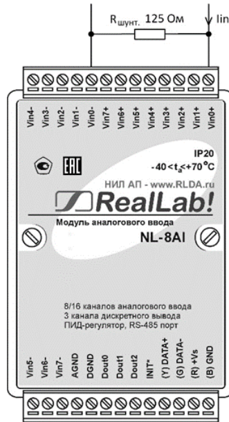
Рис. 6.8. Подключение шунтирующего резистора на первый канал модуля NL-8AI для измерения тока в диапазоне ± 20 мА, в дифференциальном режиме
