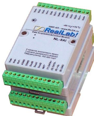
Рис. 6.2. Крепление одного модуля на другой
