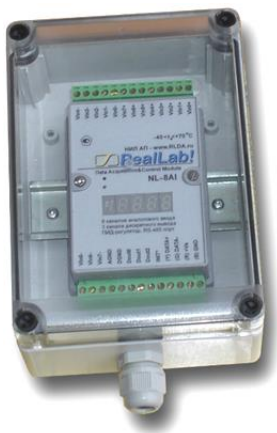
Рис. 5.4. Модуль серии NL в пылевлагозащищенном корпусе IP65 адрес, номер входного диапазона и формат данных (см. раздел 10).
