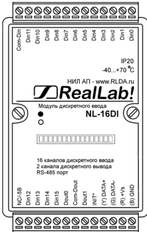
Рис. 2.1. Вид сверху на модуль NL-16DI. В модулях со логическим входом («Мокрый контакт») вывод NC свободен
