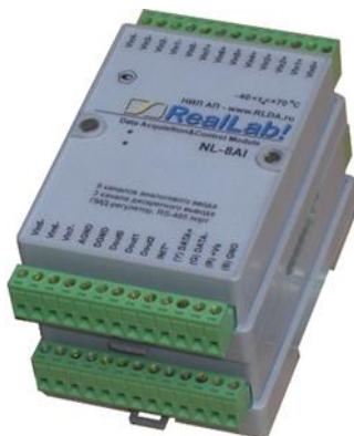
Рис. 5.2. Крепление одного модуля на другой
