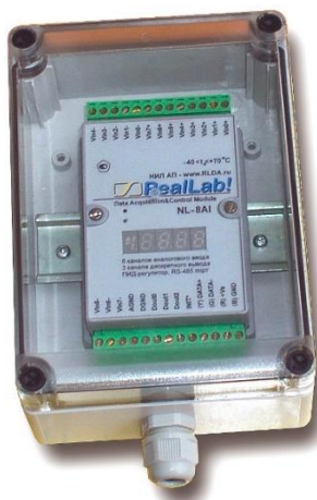
Рис. 5.3. Модуль серии NL в пылевлагозащищенном корпусе IP65
