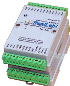
Рис. 5.2. Крепление одного модуля на другой
