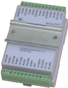
Рис. 5.1. Чтобы закрепить один модуль сверху другого, сначала закрепите ДИН-рейку сверху модуля.
