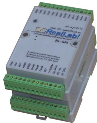
Рис. 5.2. Крепление одного модуля на другой
