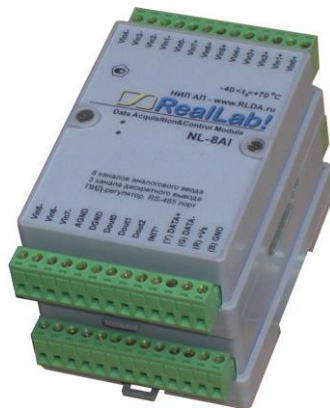
Рис. 6.2. Крепление одного модуля на другой
