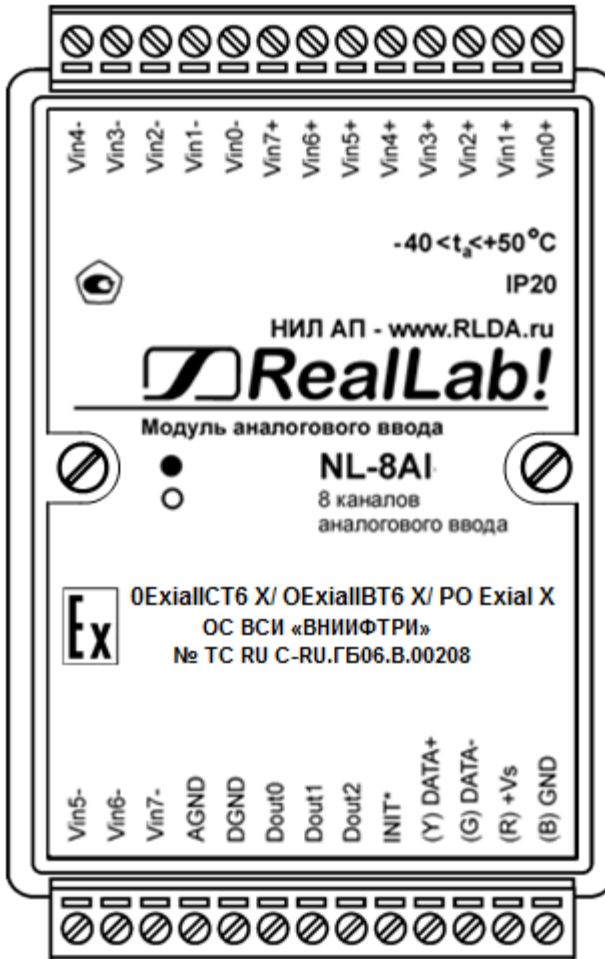
Рис. 2.3. Вид сверху на модуль NL-8AI взрывозащищённого исполнения. В режиме одиночных (не дифференциальных) входов входы Vin0-...Vin7- являются неинвертирующими входами Vin8+...Vin15+.
