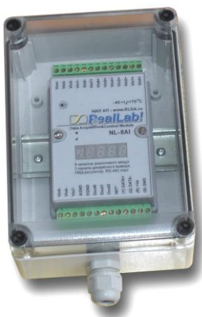
Рис. 5.2. Модуль серии NL, взрывозащищённого исполнения, в пылевлагозащищенном корпусе IP66
