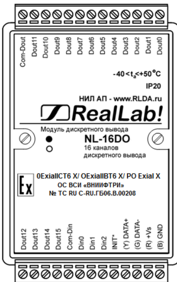
Рис. 2.2. Вид сверху на модуль NL-16DO взрывозащищённого исполнения
