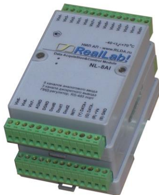
Рис. 4.4. Крепление одного модуля на другой
