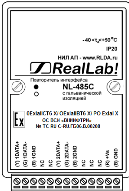
Рис. 1.1. Вид сверху на модуль NL-485C, взрывозащищённого исполнения
