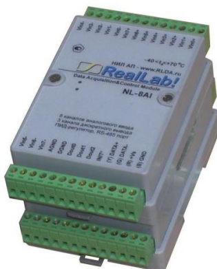
Рис. 1.4. Крепление одного модуля на другой
