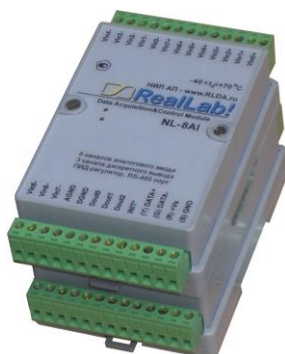
Рис. 4.2. Крепление одного модуля на другой
