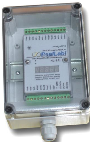
Рис. 4.3. Модуль серии NL в пылевлагозащищенном корпусе IP65
