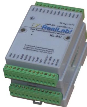
Рис. 4.2. Крепление одного модуля на другой
