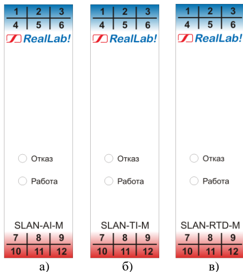
Рис. 5.1. Расположение органов индикации на лицевых панелях преобразователей а) SLAN-AI-M, б) SLAN-TI-M, в) SLAN-RTD-M
