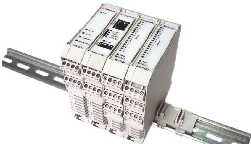
Рис. 1.1. Расположение преобразователей серии SLA на DIN-рейке, на примере модулей серии NLS
